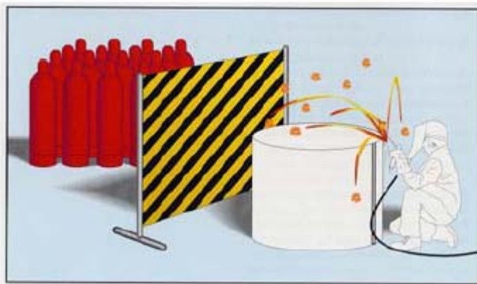
Εικ. 4.2: Παράδειγμα για μέτρα προστασίας από τους σπινθήρες σε εργασίες στις οποίες υπάρχει σπινθηρισμός.
