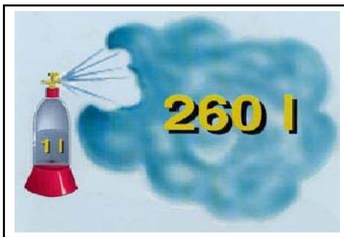
Εικ. 2.4: Ακόμη και μικρές ποσότητες εύφλεκτων υγρών μπορούν κατά την εξάτμισή τους να οδηγήσουν σε μεγάλες ποσότητες εύφλεκτων ατμών (π.χ. υγροποιημένο προπάνιο). Σημείωση: 1 λίτρο υγρού προπανίου όταν μετασχηματίζεται σε αέριο και διαλύεται στον αέρα στο κατώτερο όριο εκρηξιμότητας θα δώσει 13.000 λίτρα εκρήξιμης ατμόσφαιρας.
